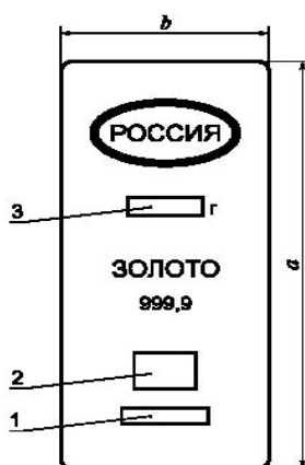
Рис. 1.Порядок расположения маркировки мерного слитка:
